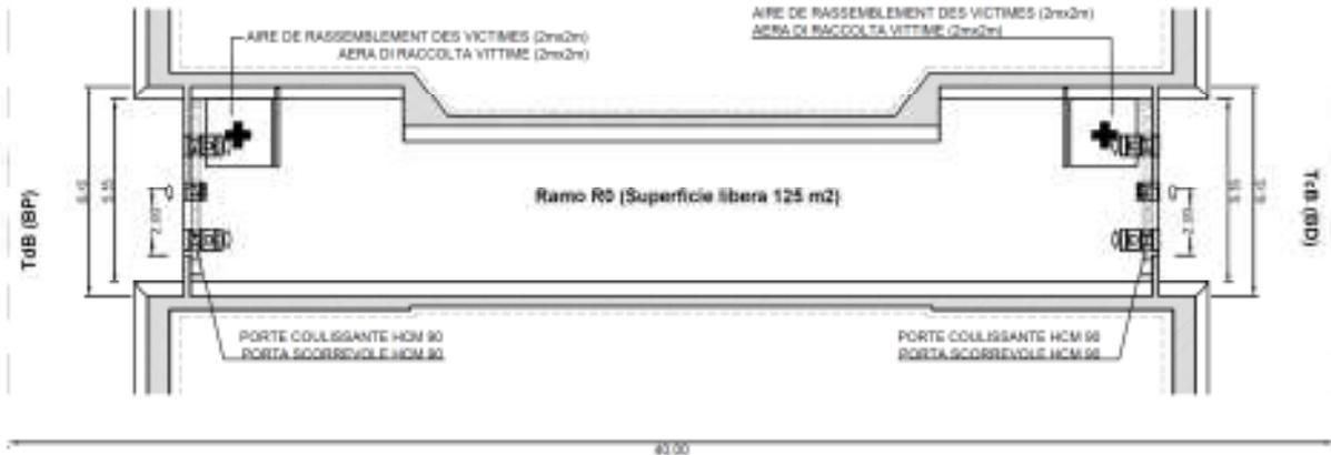
**Ramo R0-2 : Ramo di comunicazione per evacuazione di emergenza con locali tecnici contenenti gli autotrasformatori posti all'esterno del ramo;**
