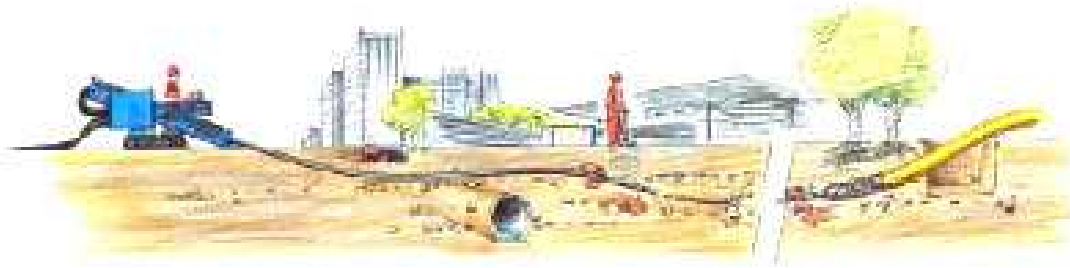
Figura 1 – Metodo di perforazione teleguidata
