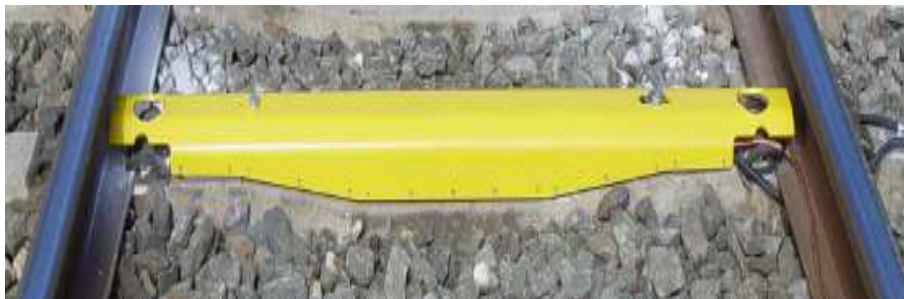
Figura 19 – Gruppo sensore di rilevamento con relativa protezione
