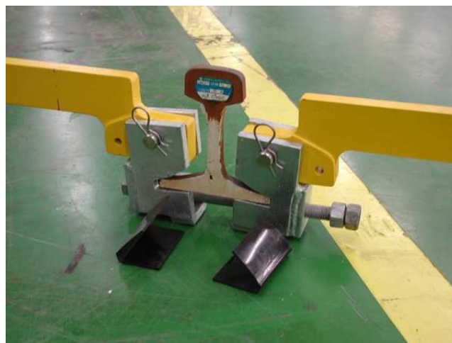
Figure 6 - Système de fixation des barres au rail
