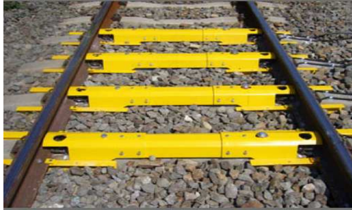
Figura 18 – Sistema di 4 sensori fissati sulla trave
