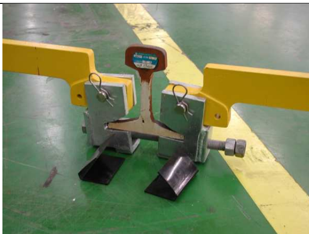
Figura 17 - Sistema di fissaggio delle barre al binario
