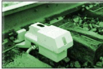
Figure 6 - Système de fixation des DBC au rail par griffe.
