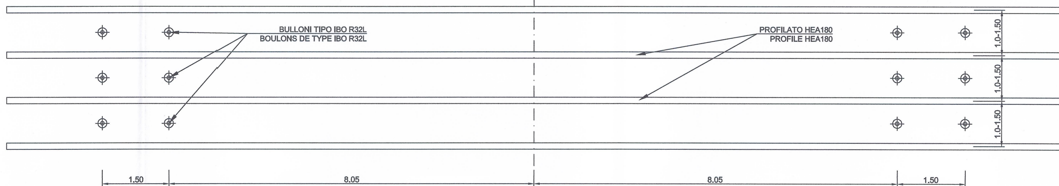
DISPOSIZIONE DEI BULLONI E CENTINE (VISTA SVILUPPATA) DISPOSITION DES BOULONS ET CINTRES (VUE DEVELOPEE)
