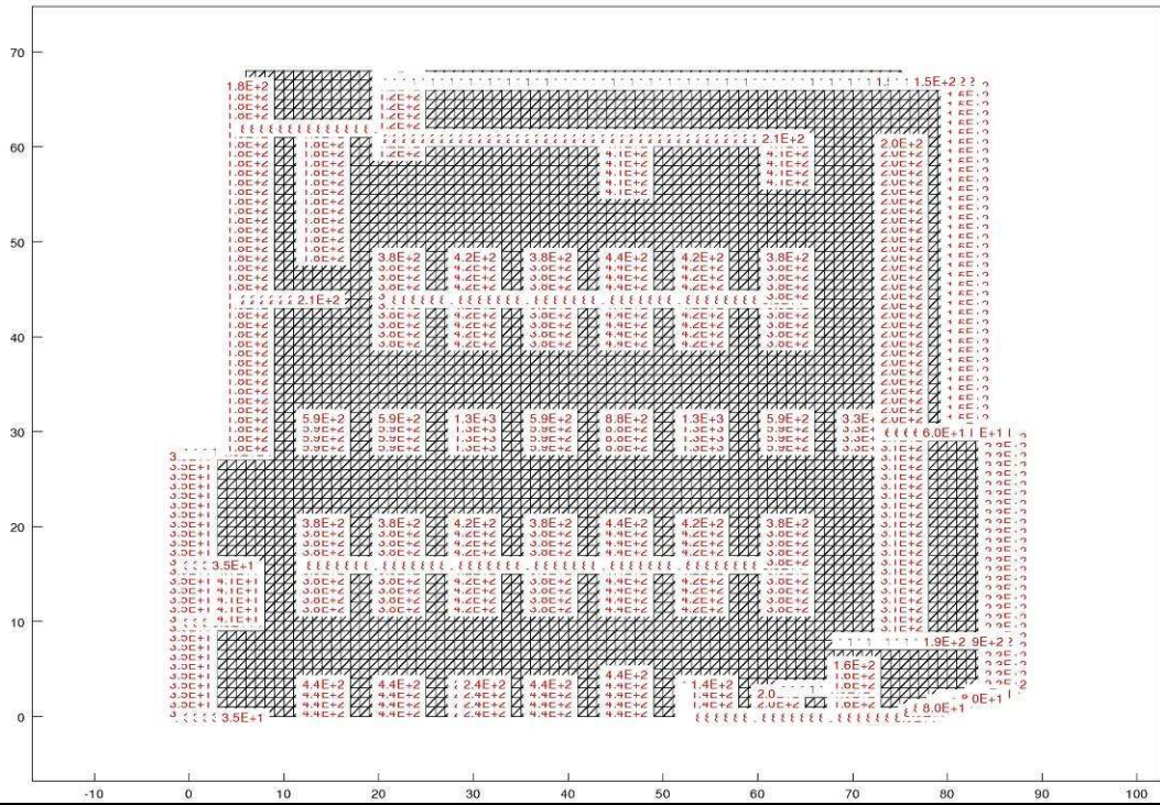
Figura 20: carichi lineari sulla platea del parcheggio (espressi in kN/m).
