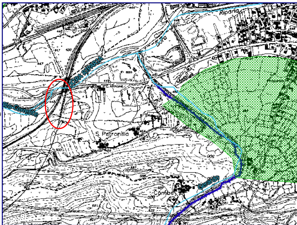
Figura 13 – Stralcio carta dei dissesti e pericolosità geomorfologica del PAI: in verde il conoide attivo non protetto del rio Gerardo Ca, in blu scuro zone a pericolo molto elevato per inondazione Ee (Fonte: sito web http://www.adbpo.it/maplab_projects/webgis consultato in settembre 2012). Il cerchio rosso indica l'area dell'imbocco e l'attraversamento sul fiume Dora Riparia.
