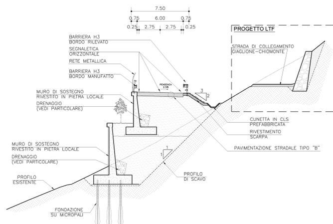
SEZIONE TIPO VIABILITA' DI COLLEGAMENTO
