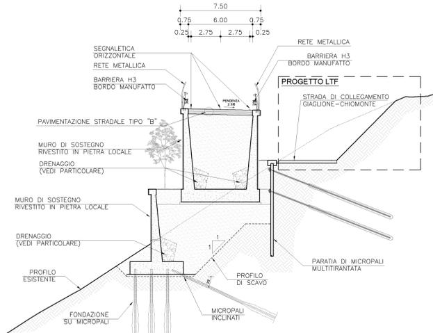
SEZIONE TIPO VIABILITA' DI COLLEGAMENTO
