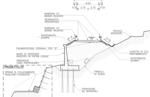
SEZIONE TIPO VIABILITA' DI COLLEGAMENTO
