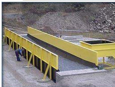
**Figura 36** – Sistemi di lavaggio dei pneumatici A DILUVIO
