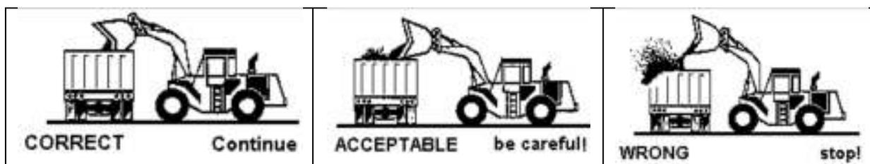
**Figura 27** – Esempio di corretto svolgimento delle attività di carico con pala meccanica
