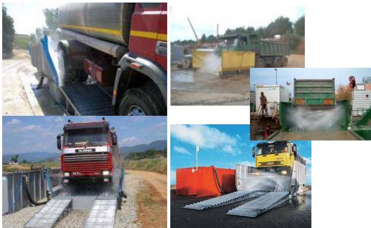
**Figura 35 – Sistemi di lavaggio dei pneumatici A PRESSIONE**
