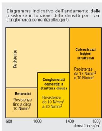
L'utilizzo della tradizionale argilla espansa tipo Leca, oltre al confezionamento di betoncini per strati isolanti e di pendenza, consente di confezionare calcestruzzi strutturali con densità 1.500 ÷ 1.600 ÷ 1900 Kg/m<sup>3</sup> e resistenze fino a 35 N/mm<sup>2</sup>.
