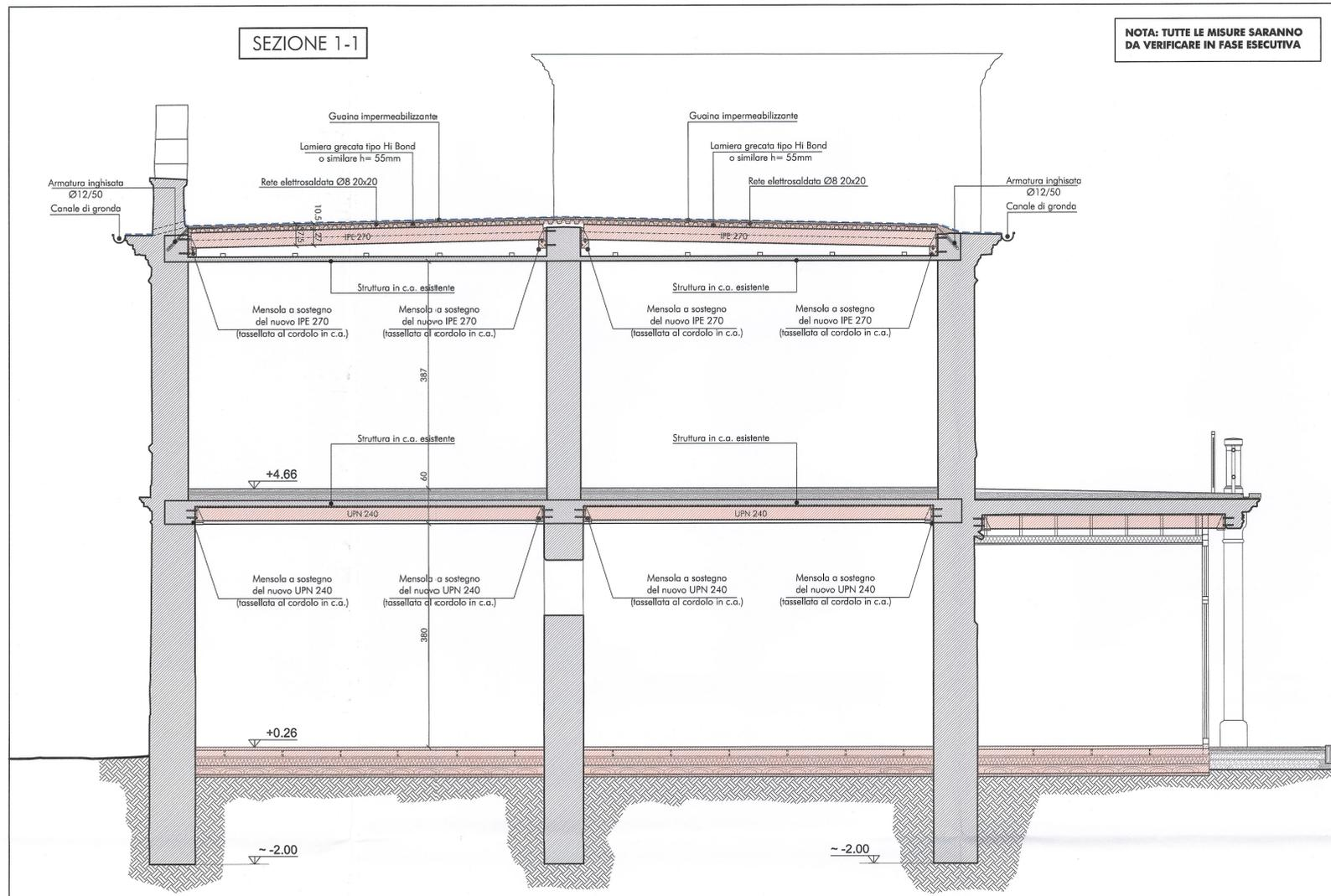
Sezione trasversale su profili metallici
