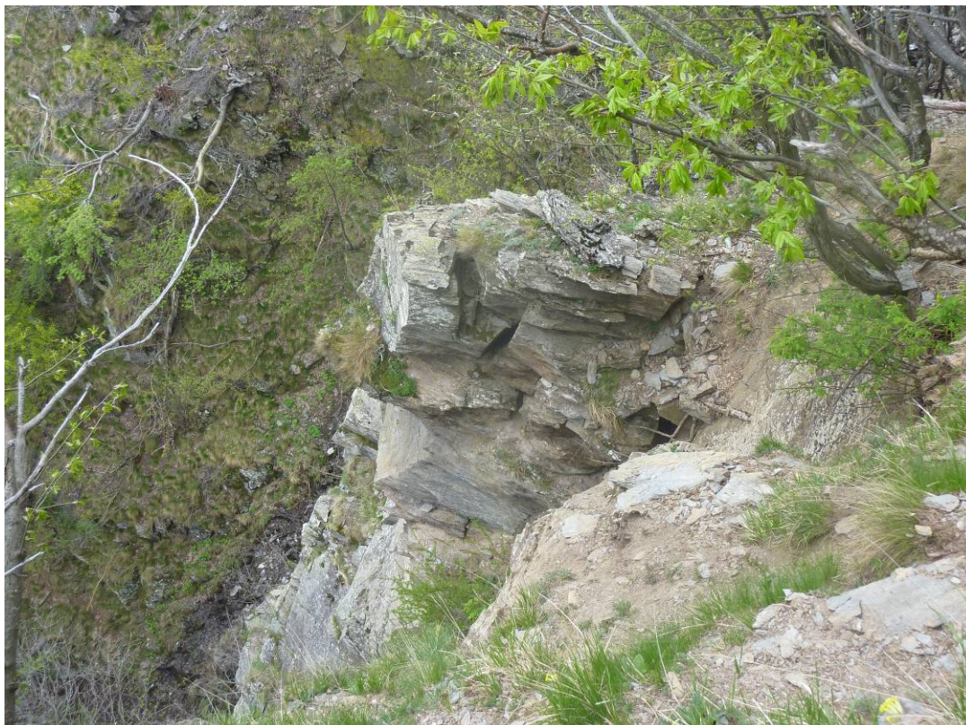
Fig. 6 – Settore roccioso destabilizzato da cinematismi tipo R1 (volume di circa 50-60 m 3 ).
