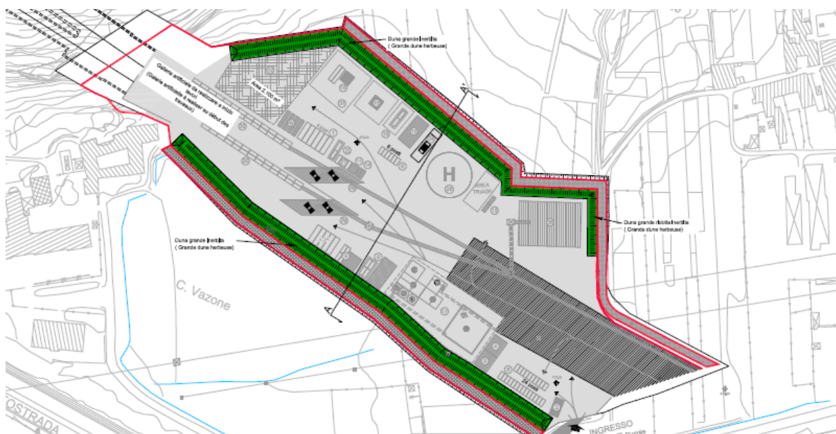
Figura 4 – Localizzazione delle dune (in verde) nel cantiere presso l'Imbocco Est del Tunnel di Base
